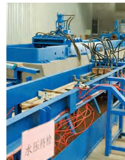
Hydraulic Testing Equipment- Equo de Prueba Hidráulica
